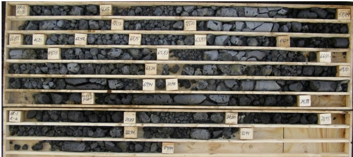
Mynd 9: Kjarni HK-01, kassar 5-6. Dýpi 56-85 m í holu. Kjarninn er mjög brotinn og kjarnaheimta léleg. Fullri sjávarseltu er náð á 70 m dýpi í holunni. Vísendingar eru um mikla lekt hvarvetna í holunni neðan vatnsborðs.
