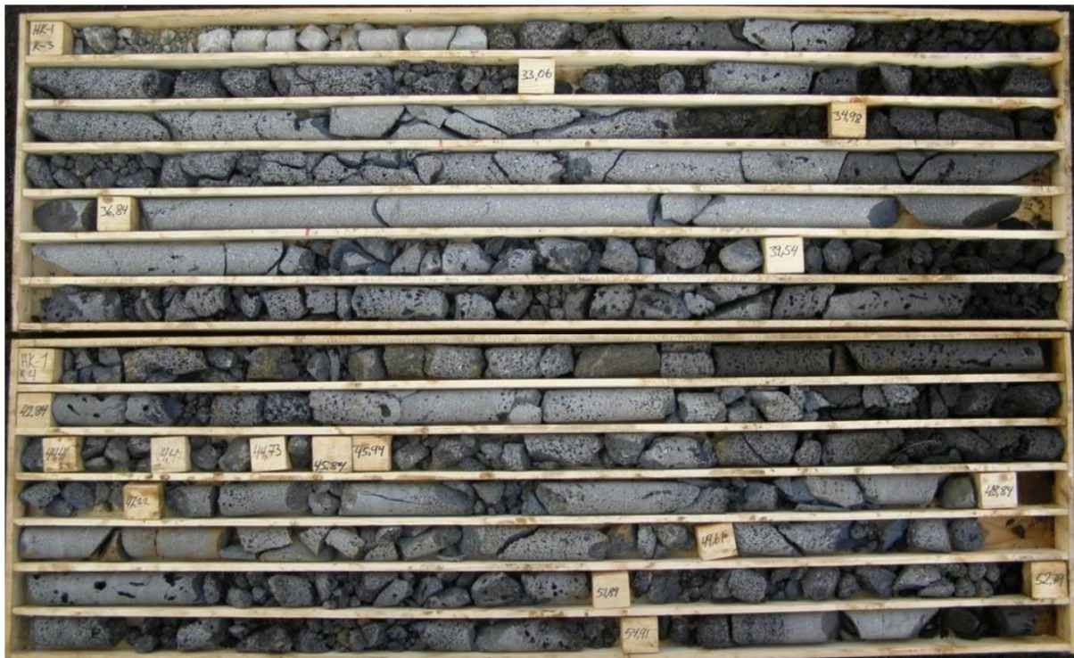
Mynd 8: Kjarni HK-01, kassar 3-4 frá 32 m og niður á 55 m dýpi. Kjarninn er talsvert brotinn og ber með sér vísbendingu um mikla lekt bergsins.
